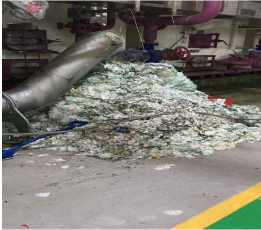
Figura 4.9 - Prensa rótulo com falha. Figura 4.10 - Prensa rótulo pós intervenção.
