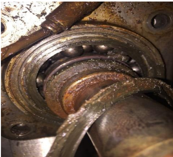
Figura 4.11 - Rolamento danificado. Figura 4.12 - Rolamento substituído.
