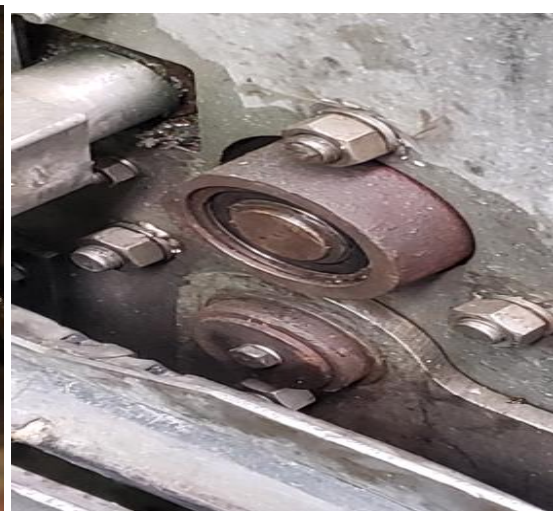
Figura 4.11 - Rolamento danificado. Figura 4.12 - Rolamento substituído.
