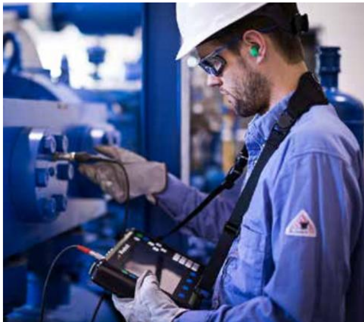
Figura 2.4 - Equipamento portátil para aquisição de dados de temperatura, vibração e pressão em motores diesel.
