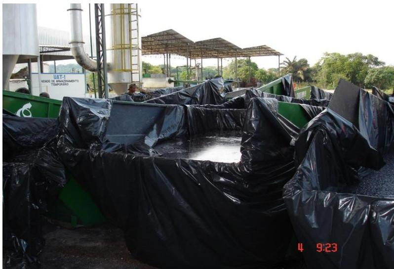
Figura 4.6 - Lodo de tinta gerado no sistema inicial.
