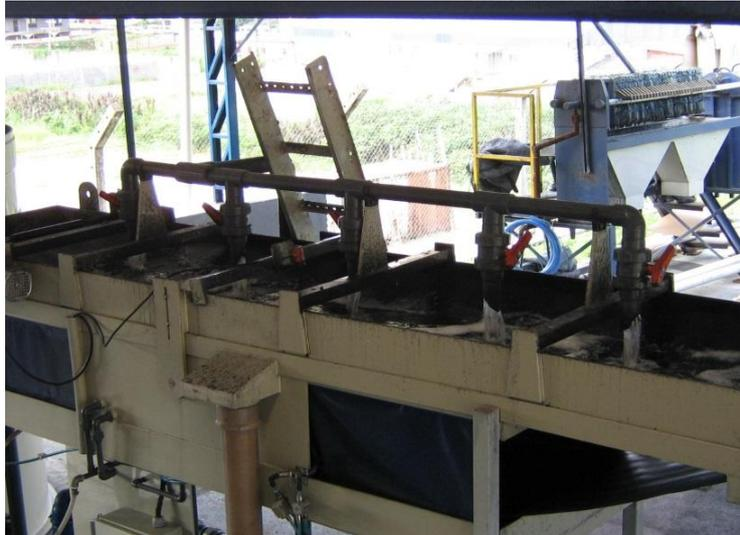
Figura 4.11 - Esteira de filtração mecânica.
