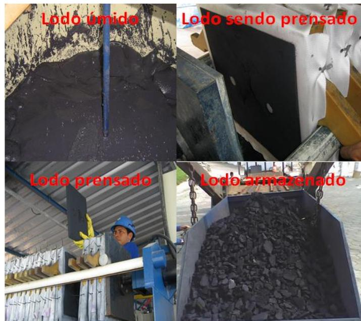
Figura 4.12 - Processo de remoção de umidade do lodo.
