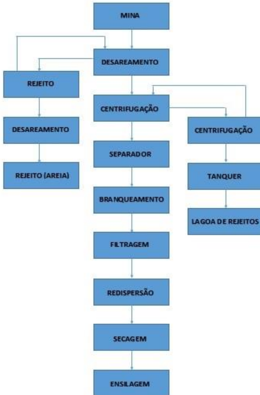
Figura 2.3: Fluxograma do processo de beneficiamento de uma indústria exploradora de caulim localizada na região amazônica. Fonte: Adaptado de Barata, 1998.
