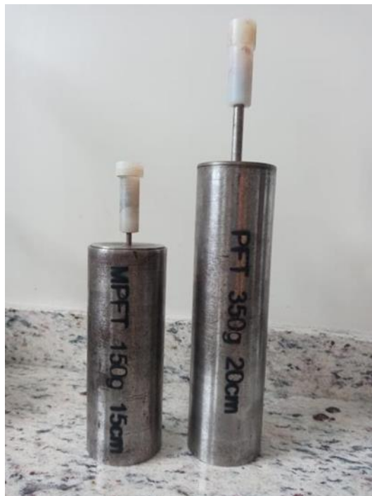
Figura 3.4 - Martelo compactador para o teste MPFT, peso do martelo 150g, com altura de queda de 15cm e martelo compactador para o teste PFT, peso do martelo 350g, tubo guia com altura de queda de 20cm, respectivamente.
