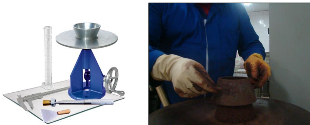
Figura 3.1 - Aparelho típico do teste de mesa de fluxo (a) e (b) amostra e remoção do molde cônico.
