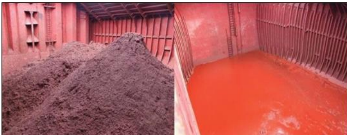
Figura 1.1 - Carga de finos de minério de ferro antes e depois da liquefação no porão do navio graneleiro.
