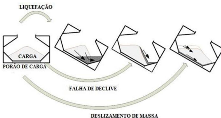
Figura 2.13 - Os três tipos diferentes de deslocamento de carga que podem ocorrer dentro de um porão de carga.
