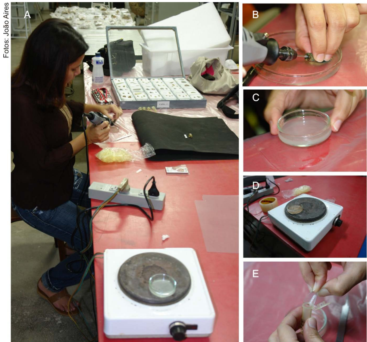
Figura 10 - (A) Aspecto geral da coleta mineralógica; B) com o auxílio de uma micro-perfuratriz elétrica foi extraída microamostras a partir do interior dos furos das contas e pingentes; C) Amostra imersa em álcool em recipiente de vidro; D) Aquecimento do recipiente para que o álcool evapore e permaneçam somente os resíduos da amostra; E) Coleta do material.
