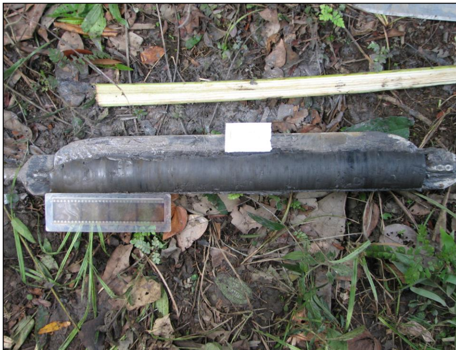
Figura 9 - Trado russo contendo testemunho sedimentar retirado da vereda da topossequência FC no intervalo de 100 a 150 centímetros de profundidade.
