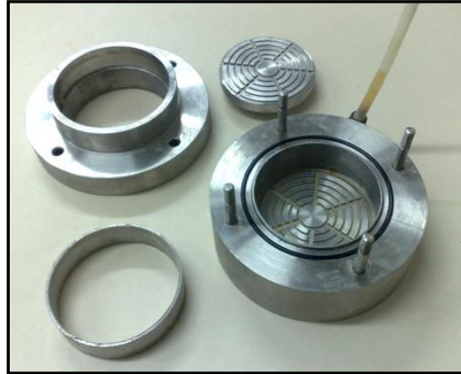
Figura 4.7 - Célula em aço inox para ensaios edométricos.
