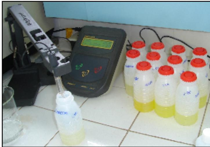
**Figura 3.4** – Tratamento realizado para adsorção do rejeito caulínítico saturado com  $\text{NaClO}_4\text{-HClO}_4$ .
