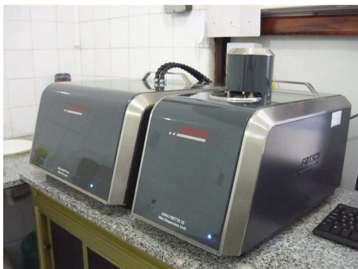
**Figura 10 – Analisador de Partículas por Difração a Laser Analysette MicroTec Plus – LaMiGA/UFPA**
