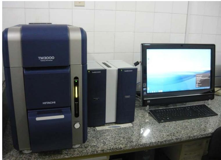
**Figura 11 - Microscópio eletrônico de varredura modelo TM3000 Tabletop Microscope - LaMiGA/UFGA**
