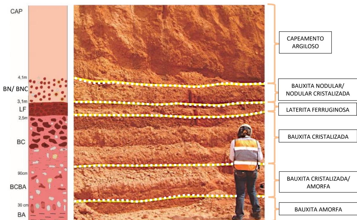
Figura 6 - Desenho esquemático do perfil bauxítico. Adaptado de Kotschoubey (2005).
