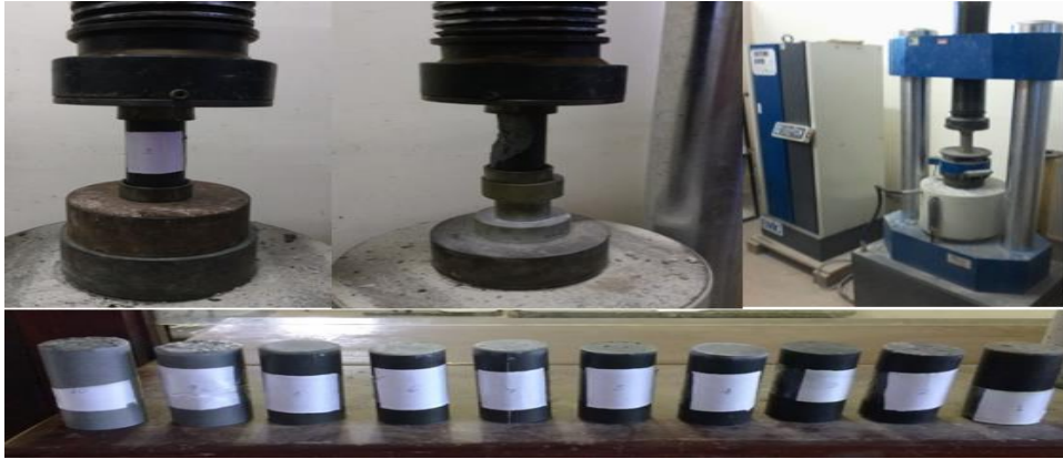
Figura 3.7: Ensaio de resistência à compressão dos geopolímeros
