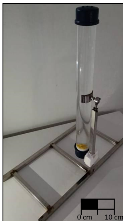
Figura 6 - Estrutura metálica em aço inoxidável que permite apoio, fixação e rotação do tubo.
