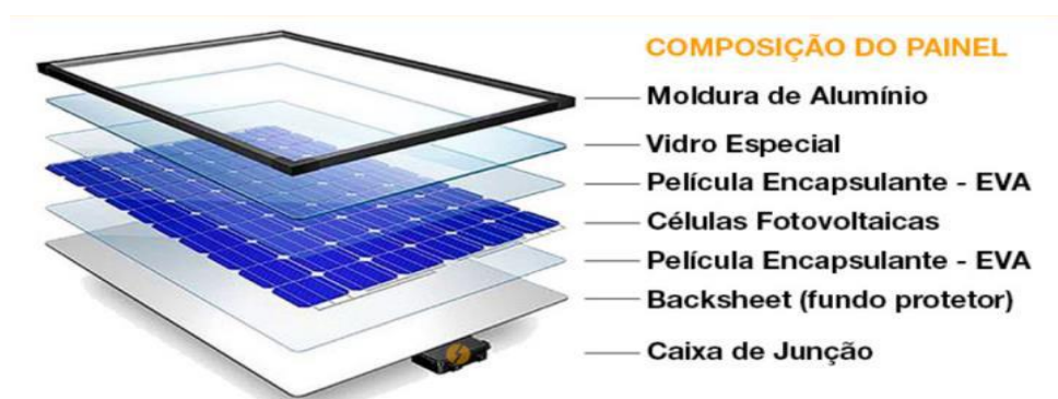
Figura 2.17 - Composição de um painel fotovoltaico. Fonte: BLUE SOL (2019).
