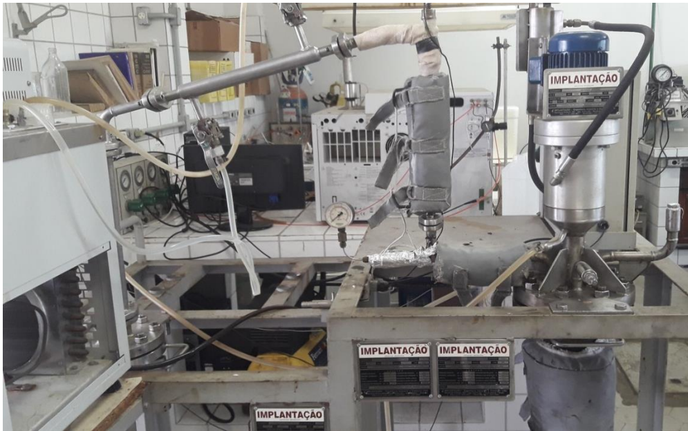
Figura 19: Unidade de craqueamento termocatalítico em escala semi-piloto utilizado nos experimentos de upgrading.
