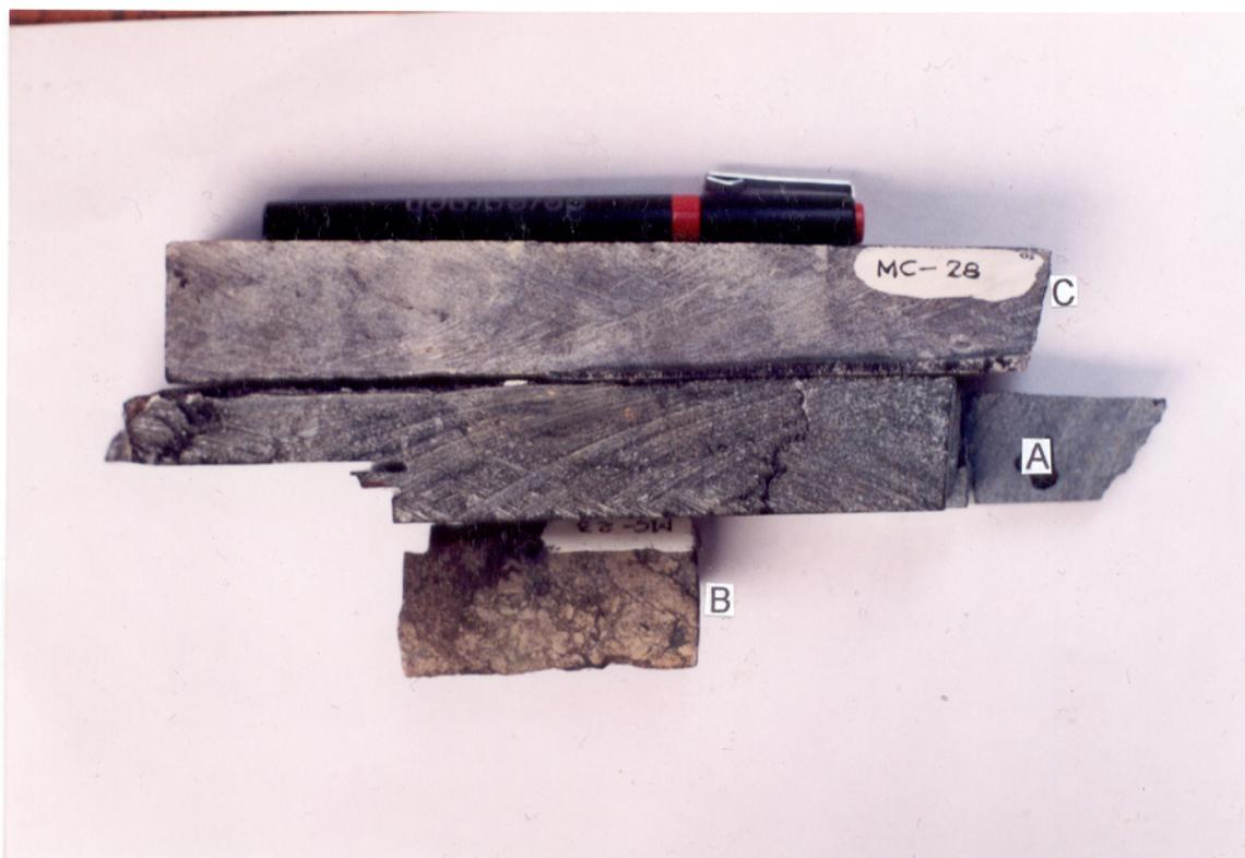
**Figura 12** - (A) Brecha com matriz rica em clorita, turmalina, siderita (sd) e calcopirita; (B) Brecha com matriz rica em siderita e calcopirita; (C) Brecha com matriz rica em quartzo.
