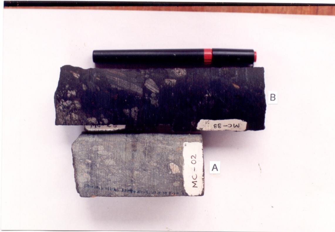
**Figura 6** - (A) Brecha com matriz rica em clorita e clastos de metavulcânicas básicas; (B) Brecha com predomínio de clastos de formações ferríferas bandadas.
