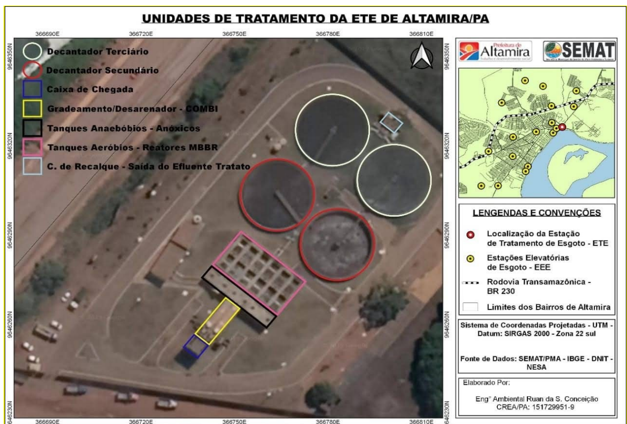
Mapa 7 - Ilustração dos locais onde ocorrem o tratamento de esgoto Fonte: SEMAT (2019). Org: Ruan Conceição (2019)
