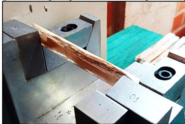
Figura 46 - Corpo de prova em ensaio de impacto Charpy.
