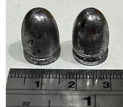
Figura 51 – Munição calibre .45 ACP fornecida pelo laboratório de ensaio balístico / IME-RJ.
