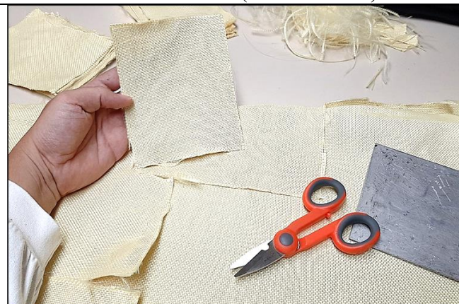
Figura 39 – Cortes no tecido de Aramida (Twaron® T750) com a tesoura elétrica.
