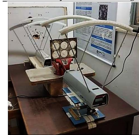
Figura 52 - Sistema de detecção no ensaio de energia de absorção.
