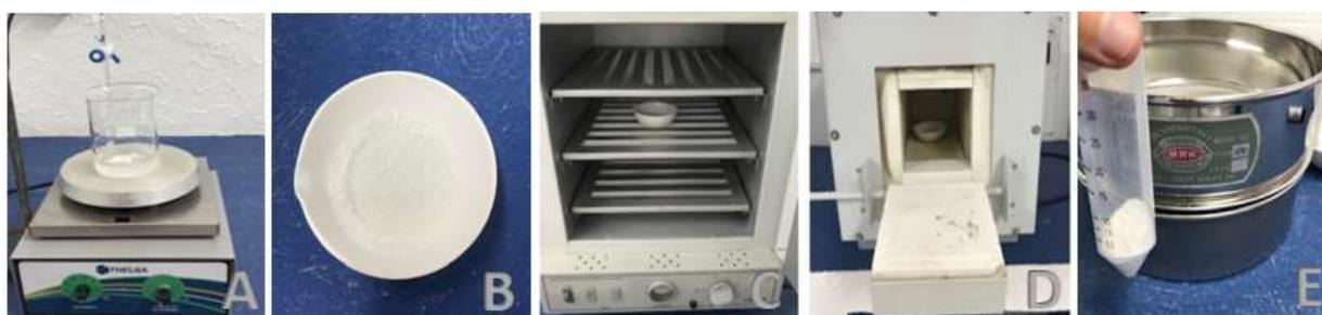
Figura 8: Processo de obtenção do biovidro via rota sol-gel: (A) Solução ácida agitada magneticamente no reator termostado; (B) Gelificação da solução. (C) Gel em estufa. (D) Calcinação em mufla. (E) Peneiramento para redução de granulometria.
