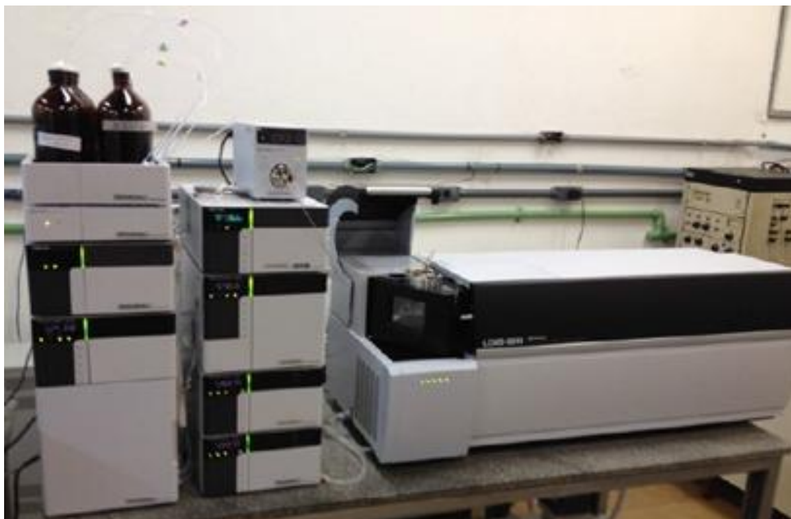
Figura 20 - Sistema de Cromatografia Fase Líquida acoplado à Espectrometria de Massas - HPLC-LC-MS/MS 8040 (Shimadzu). Fonte: LABMASSAS/UFOP, 2019.
