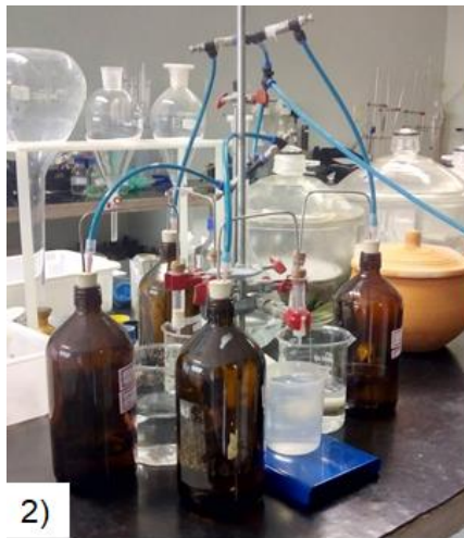
Figura 17 - Sistema de extração para SPE (aparelho extrator) utilizado no LAMAG/UFPA.
