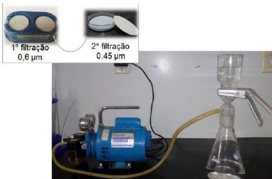
Figura 15 - Sistema de filtração e filtros utilizados na ALF. Fonte: Adaptado de Chaves, 2020
