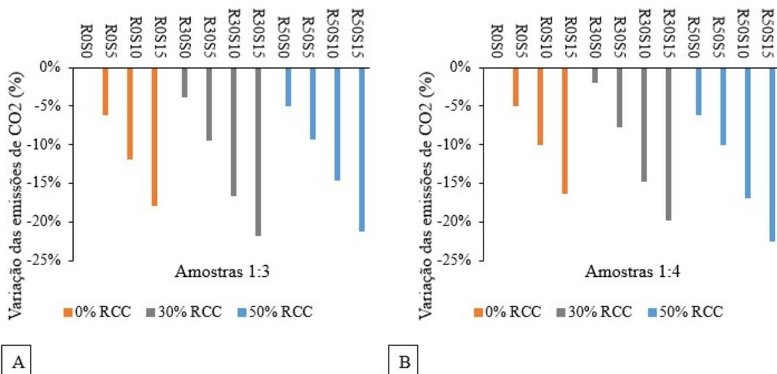
Figura 23 – Variação das emissões de CO<sub>2</sub> das argamassas. A) Traço 1:3. B) Traço 1:4.
