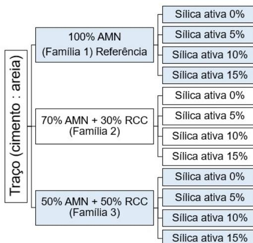
Figura 7 - Representação esquemática dos traços (1:3 e 1:4). Fonte: Autor, 2023.
