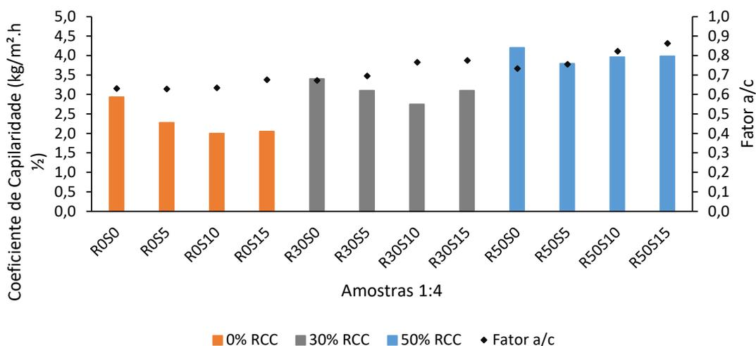
Figura 18 - Resultados médios do coeficiente de absorção de água por capilaridade frente ao fator a/c. Traço 1:4.
