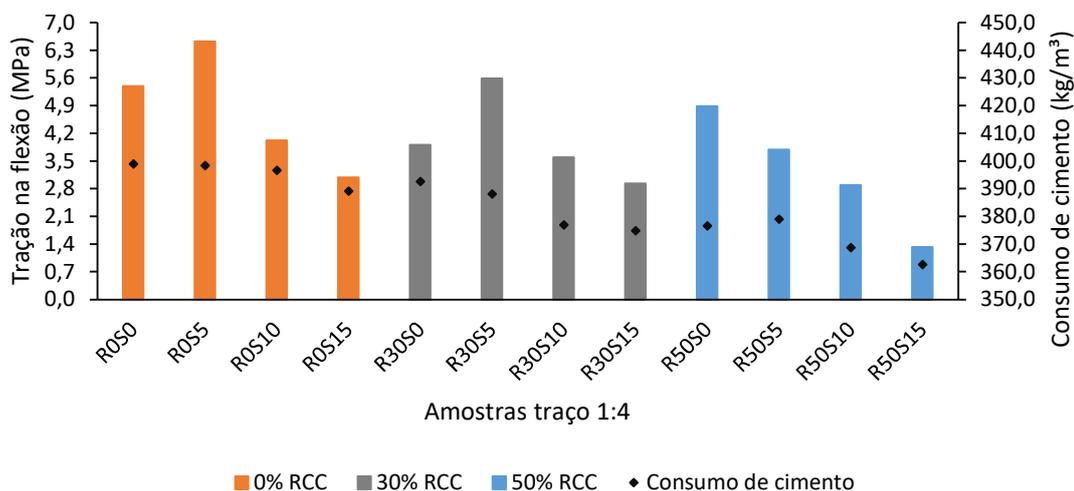
Figura 20 - Resultados médios da resistência à tração na flexão das argamassas frente ao consumo de cimento. Traço 1:4.
