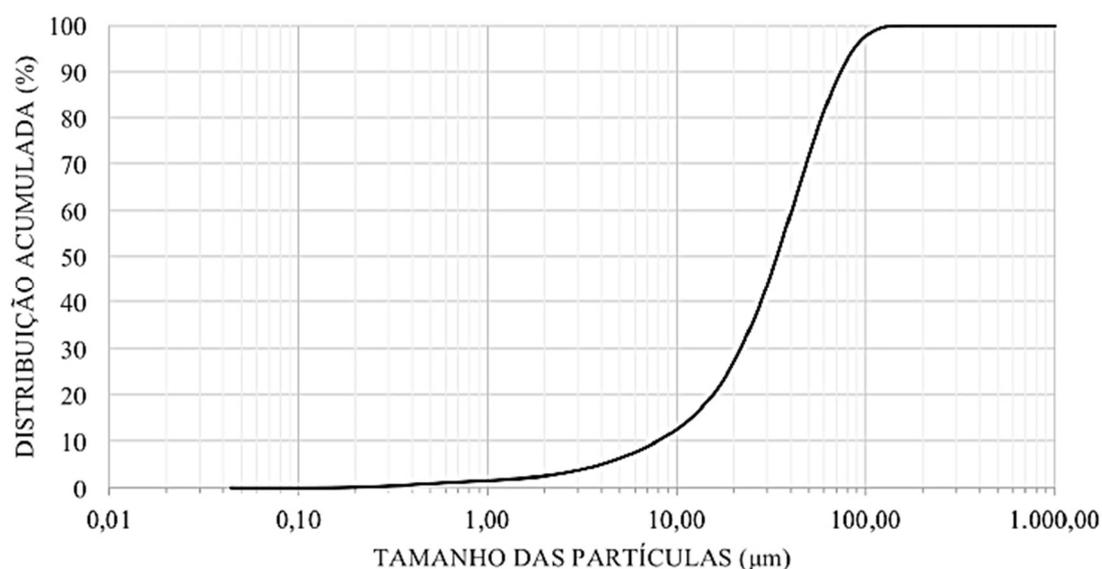
Figura 4 - Curva granulométrica da sílica ativa. Fonte: Autor, 2023.
