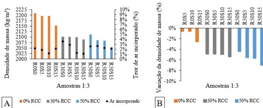
Figura 10 - Resultados médios das argamassas 1:3. A) Densidade de massa. B) Variação da densidade de massa.
