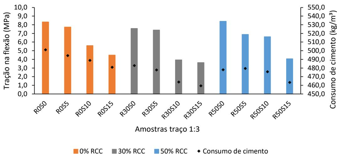
Figura 19 - Resultados médios da resistência à tração na flexão das argamassas frente ao consumo de cimento. Traço 1:3.
