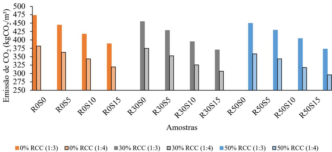
Figura 21 – Resultados médios das emissões de CO<sub>2</sub> das argamassas.
