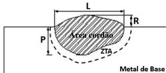
**Figura 3.35** – Esquema representativo das grandezas geométricas do cordão de solda. **Fonte:** Autor (2022).
