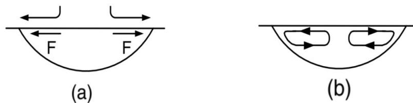
**Figura 2.43** – Esquema da atuação da tensão de cisalhamento causada pelo plasma do arco. **Fonte:** Adaptado de Kou (2003).
