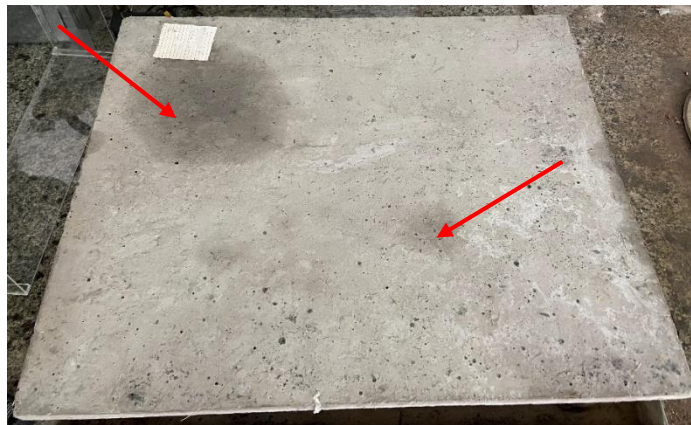
Figura 48: Face inferior da placa cimentícia com reforço de fibras com tratamento. Fonte: AUTORA, 2022
