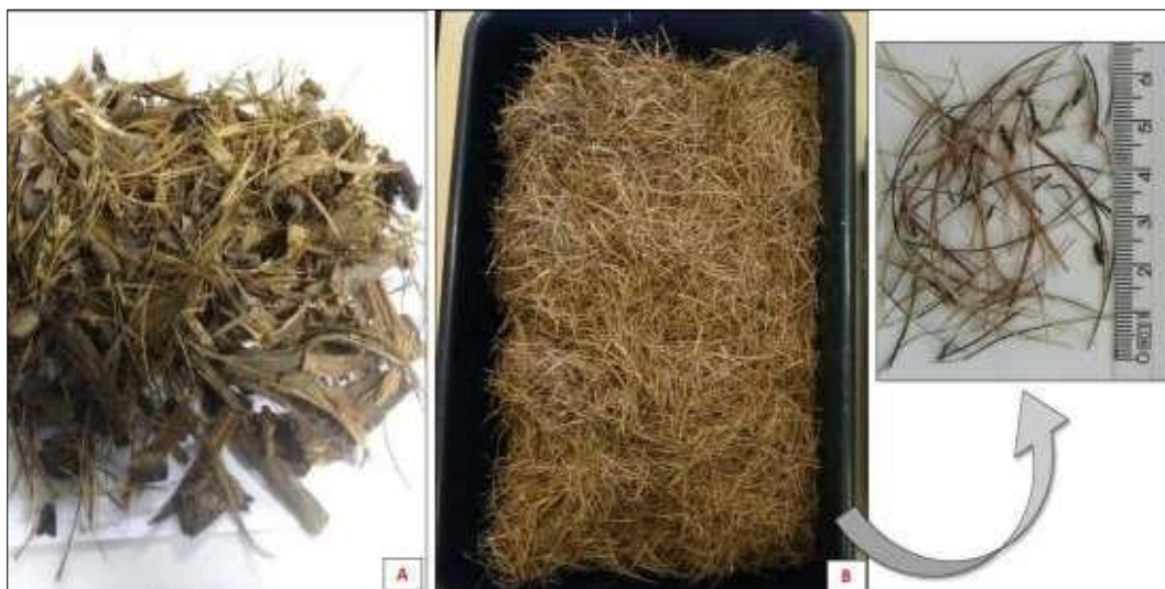
Figura 8: Fibras do epicarpo do coco babaçu, antes (A) e após (B) o beneficiamento. Fonte: RODRIGUES, 2019.
