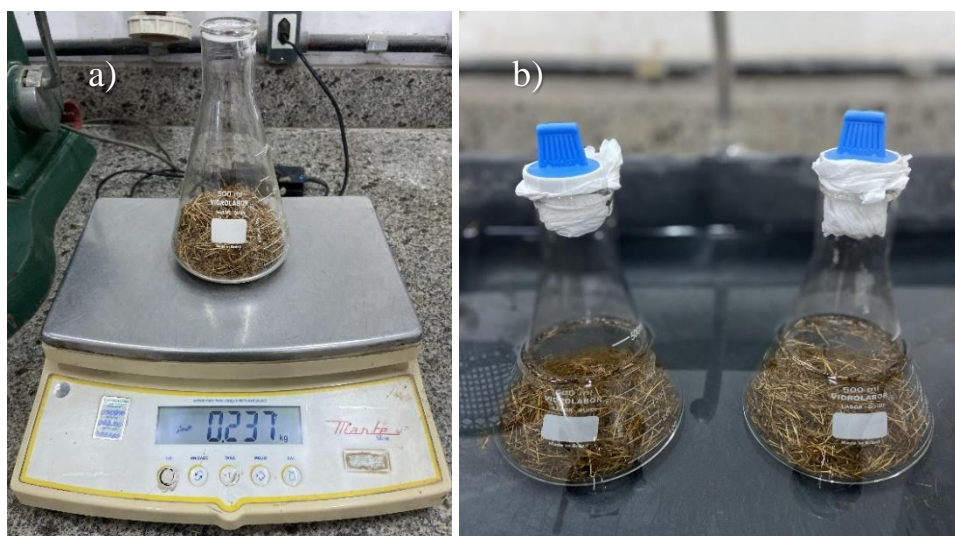
Figura 16: Determinação da massa específica: a) fibra inserida no frasco, b) amostra em banho. Fonte: AUTORA, 2022.
