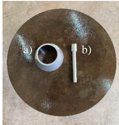
Figura 19: Tampo da mesa, (a) parede do molde troncônico, (b) soquete. Fonte: AUTORA, 2022.
