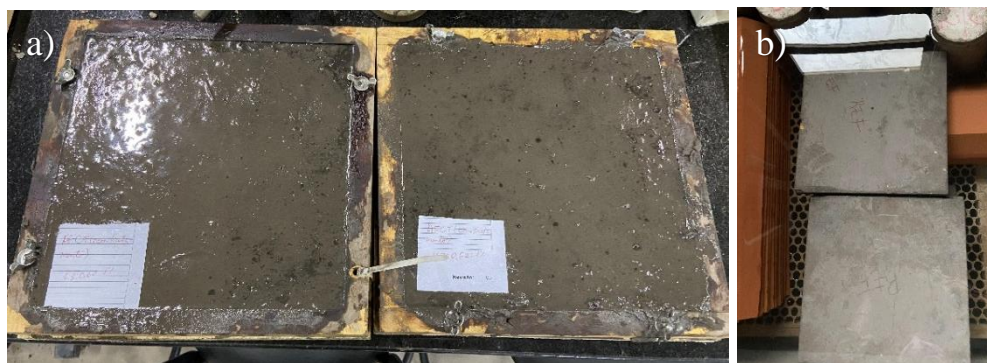
Figura 36: Placas cimentícias. (a) submetidas ao processo inicial de cura em superfície rígida, (b) em tanque para cura úmida de 28 dias. Fonte: AUTORA, 2022
