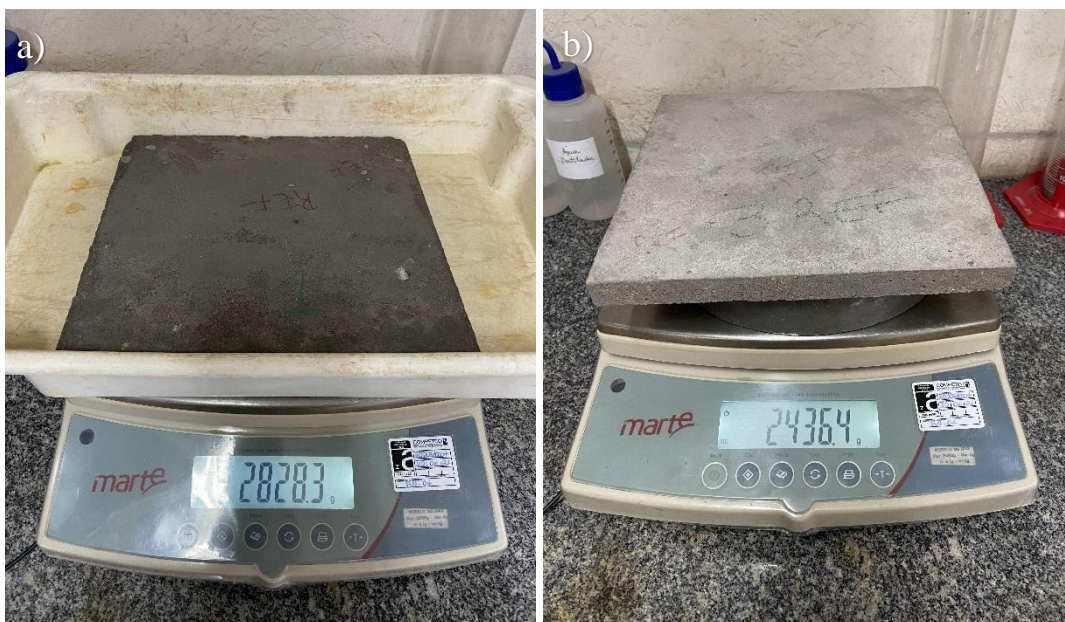
Figura 27 – Pesagem da placa cimentícia. a) em estado saturado, b) após secagem em estufa. Fonte:
