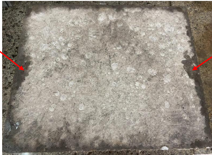
Figura 47: Face inferior da placa cimentícia com reforço de fibras in natura . Fonte: AUTORA, 2022.
