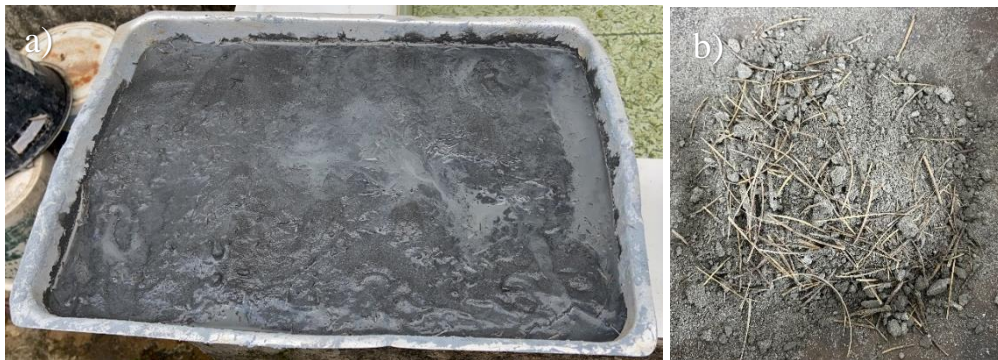
Figura 35: Fibras do epicarpo do coco babaçu, (a) Impregnadas em pasta de sílica ativa, (b) em processo de secagem ao ar. Fonte: AUTORA, 2022.
