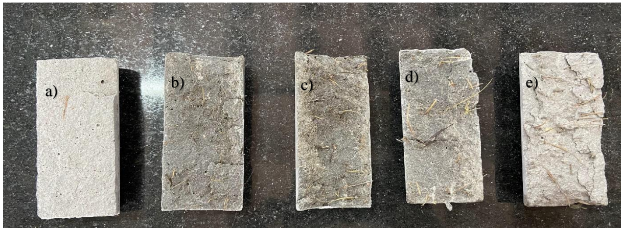
Figura 23 – Faces internas de cada corpo de prova submetidos ao ensaio de resistência à tração das misturas, a) de referência, b) com fibras 1% \leq 25, c) com fibras 1% > 25, d) com fibras 2% \leq 25, e) com fibras 2% > 25. Fonte: AUTORA, 2022.
