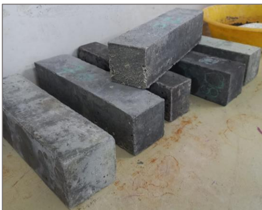
Figura 30 - Corpos de prova prismáticos para ensaio de carbonatação acelerada. Fonte: AUTOR (2022).
