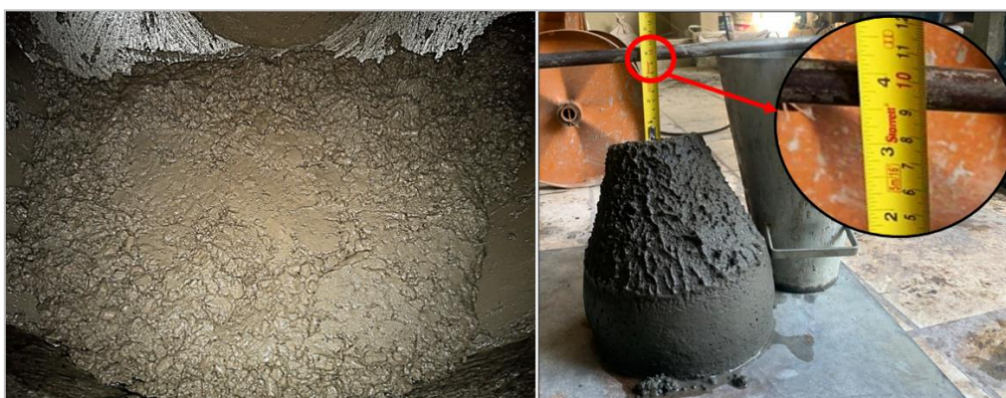
Figura 27 – Aspectos visuais apresentados pelos concretos durante a dosagem. Fonte: AUTOR (2022).
