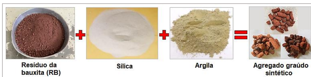
Figura 23 – Matérias primas de composição do agregado graúdo sintético.
