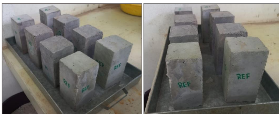
Figura 33 - Corpos de prova prismáticos para ensaio de penetração de íons cloreto. Fonte: AUTOR (2022).
