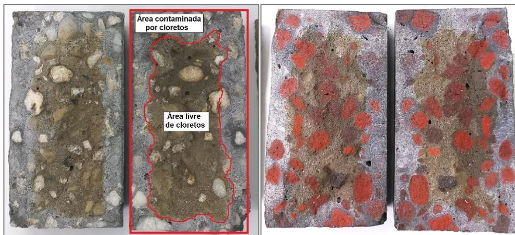
Figura 36 - Esquematização das seções longitudinais aspergidas com solução de \text{AgNO}_3 . Fonte: AUTOR (2022).
