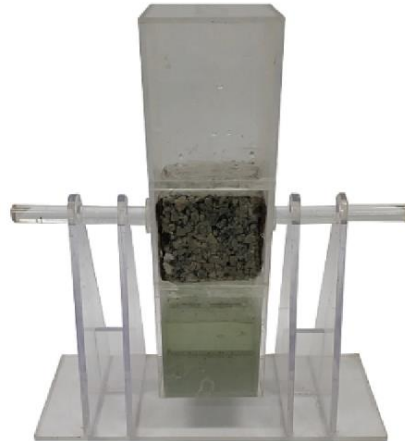
Figura 13: Dispositivo de teste de adsorção para concreto permeável geopolimérico.
