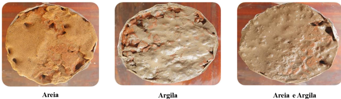
Figura 42. Acúmulo de sedimentos após ensaio de colmatação nos corpos de prova.
