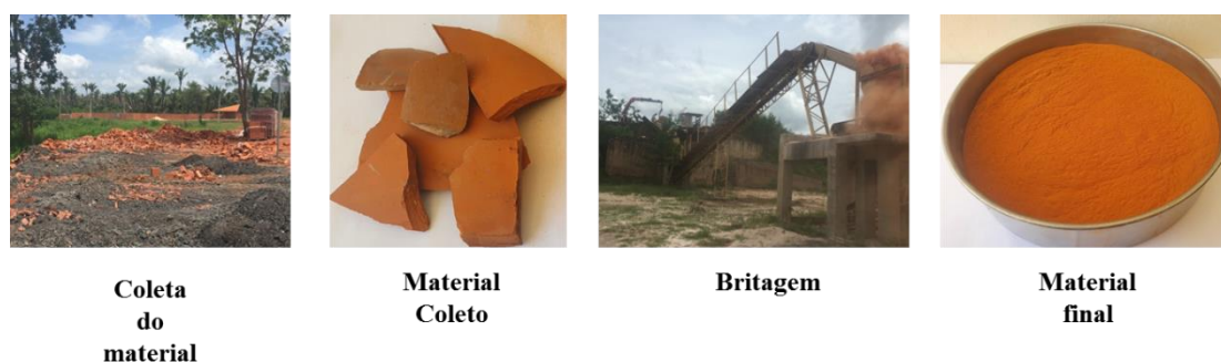
Figura 20. Processo de obtenção da cerâmica vermelha.
