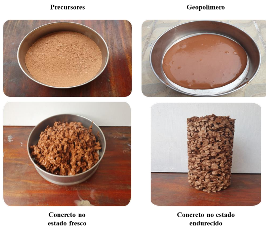
Figura 33. Processo de produção do concreto permeável geopolimérico.
