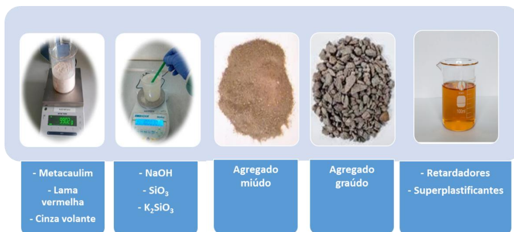
Figura 8: Componentes do concreto geopolimérico.
