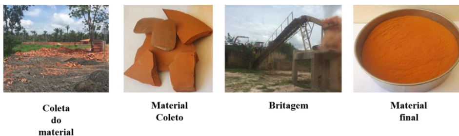
Figura 32. Processo de obtenção da cerâmica vermelha.
