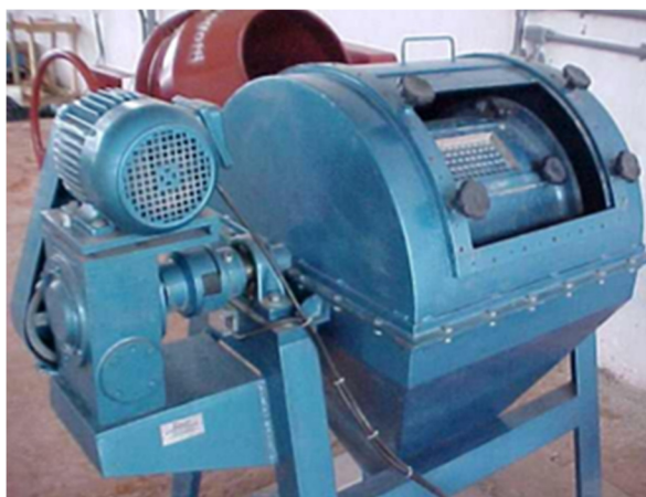
Figura 10 - Moinho rotativo utilizado na redução da granulometria do resíduo de silício
