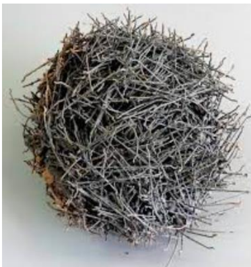
Figura 2.5. Aglomerado de fibras de aço (ourição) mal misturadas ao concreto (FIGUEIREDO, 2011)
