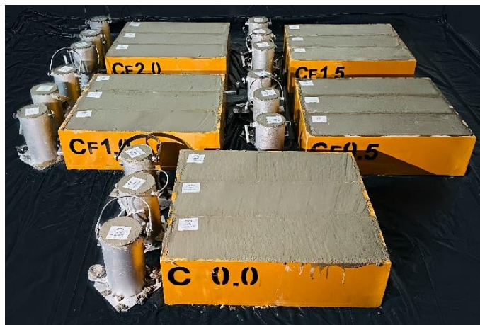
Figura 5.3. Vigas moldadas e seus respectivos corpos de prova cilíndricos.
