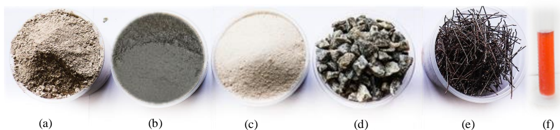
Figura 5.2. Materiais utilizados: (a) Cimento Portland CII-Z-32 RS, (b) Sílica, (c) Areia, (d) Agregado graúdo, (e) Fibras de aço (DRAMIX® 3D 65/60 BG) e (f) Aditivo Superplastificante.
