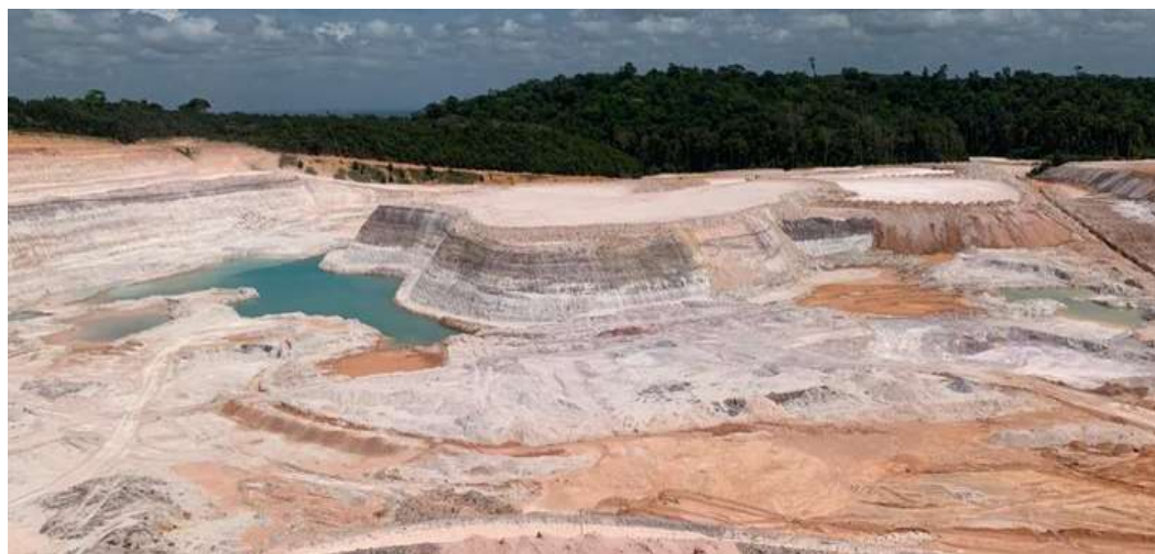
Figura 20 – Lagoa de depósito do resíduo do beneficiamento do caulim.
