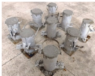
Figura 5.14 – Moldagem dos corpos de prova
