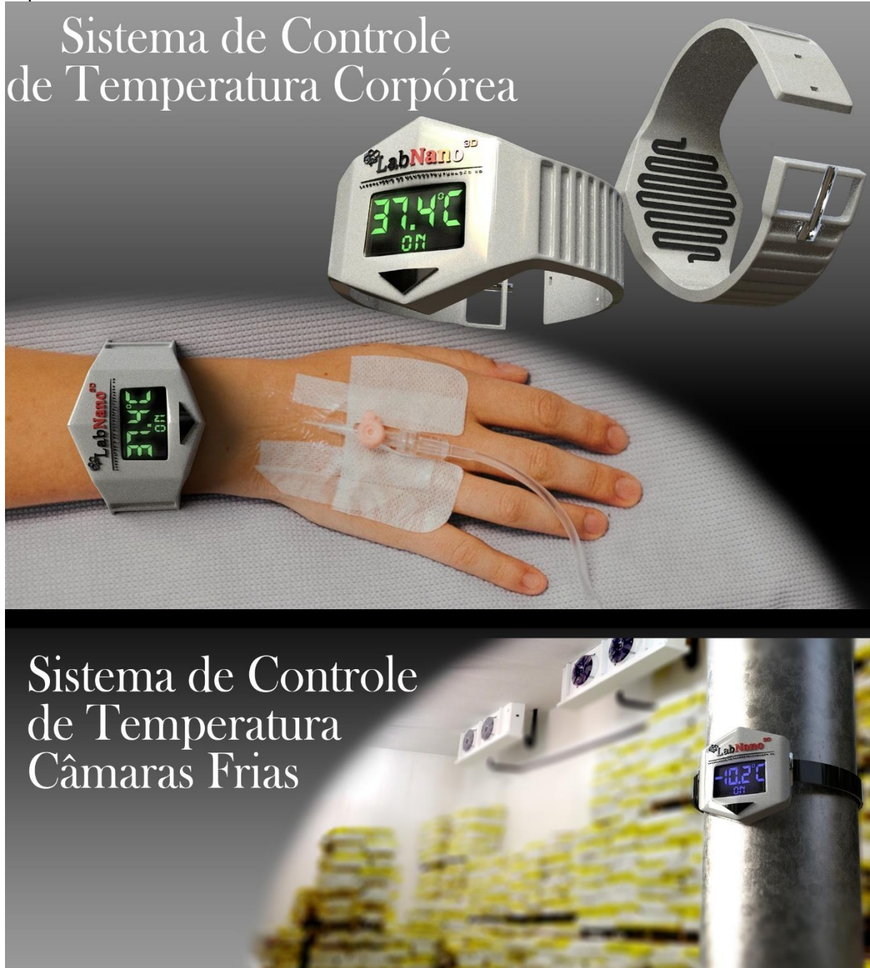
Figura E. 1 – Sistemas Conceitual de Controle de Temperatura Corpórea e de Câmaras Frias- Ambos os dispositivos possuem um formato Hexagonal e dimensão de 8 x 6 x 1,5cm. Em sua parte inferior, apresenta uma serpentina em PLA/NTCs como elemento sensor.
