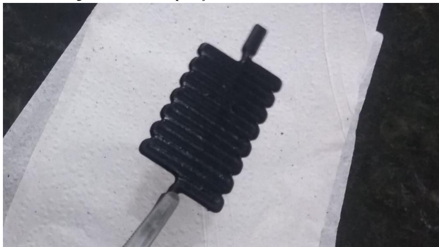
Figura 22 – Resultado da segunda camada de aplicação de tinta PLA/NTCs no sensor A3.
