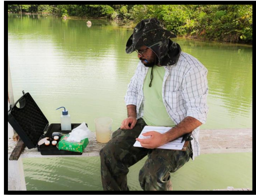
Figura 3- Procedimentos de leituras In Situ dos parâmetros físico-químicos no rio Apeú.
