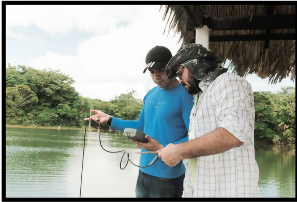
Figura 3- Procedimentos de leituras In Situ dos parâmetros físico-químicos no rio Apeú.
