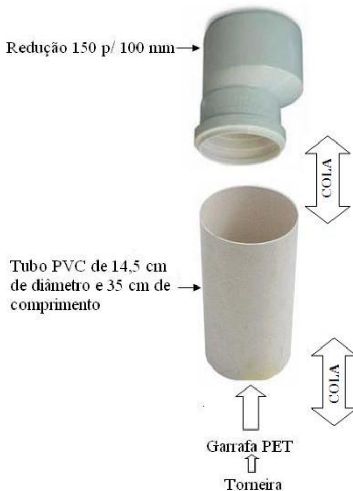
Figura 2- Esboço do corpo do pluviômetro utilizado no projeto.
