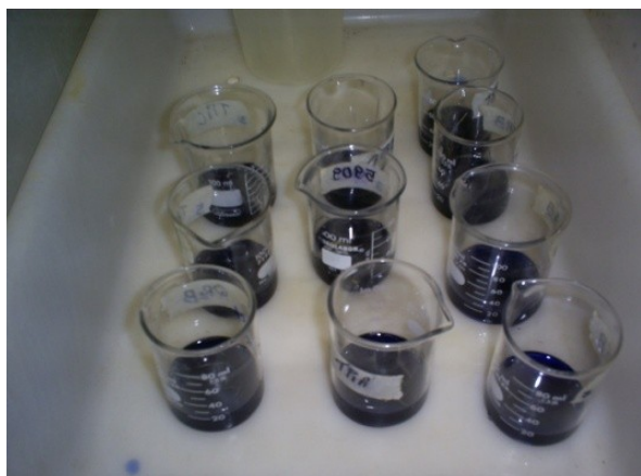
APÊNDICE O- Coloração das raízes com solução de 0.05% de azul de Tripán em glicerol acidificado (0.5 g/L).
