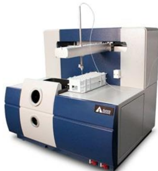
Figura 15: Equipamento de espectrometria de absorção atômica, por meio desse equipamento podemos saber quais as espécies químicas estão presentes numa amostra submetida a exame. Fonte: Dctech (2017).
