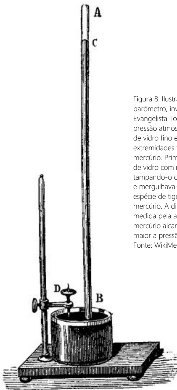
Fig. 276. — baromètre à cuvette et sa pointe.
