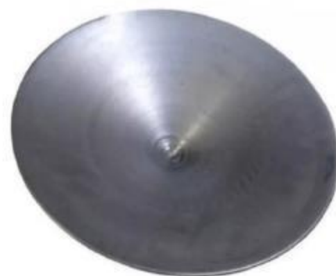
Figura 22: A bateia é uma espécie de cuiá metálica utilizada na mineração de aluviões. Fonte: WikiMedia.
