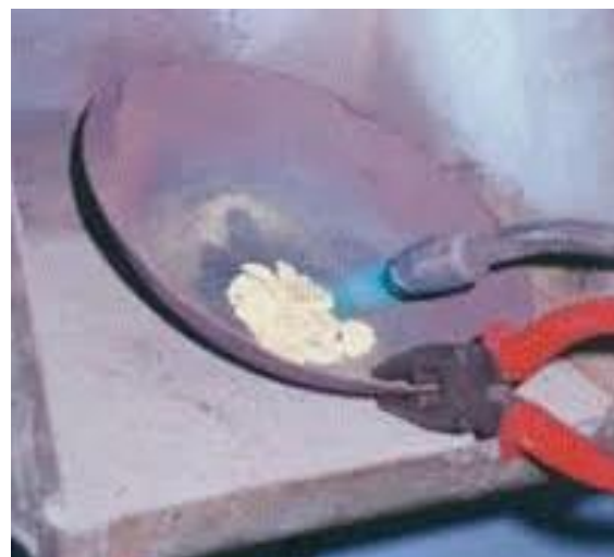
Figura 20: Imagem de amalgama de ouro e mercúrio sendo queimado, para separar o mercúrio da amostra. Fonte: Silva, Batista e Bernstein (2014)
