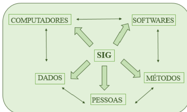
Figura 2: Cinco componentes estruturais de um SIG.
