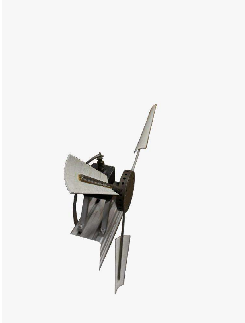
Figura 9. Detalhe da pá reta de perfil arco-circular de corda constante e ângulo de torção \theta .
