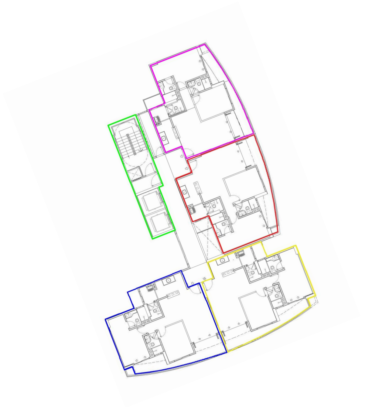
Figura 14 – Compartimentação do pavimento tipo do edifício C
