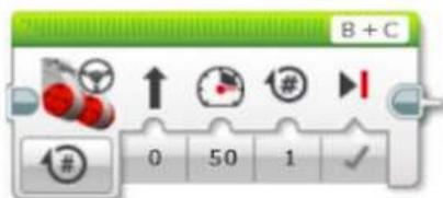
Usado para movimentar o robô para frente e para trás; virar com os 2 pneus
