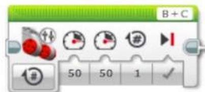
Usado para movimentar o robô para frente e para trás; virar no próprio eixo, travando um dos motores
