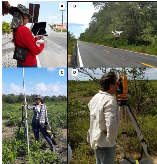
Figura 3- A) Ipad com software DJI Ground Station Pro instalado. (B) Drone Phantom 4 Advanced (C) e (D) Antenna Catalyst, GPS de alta precisão para recolecção dos GCPs.
