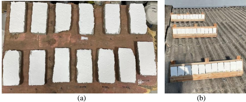
Figura 29 - Resistência ao intemperismo: (a) Pintura dos corpos de prova e (b) Exposição a Intempéries.
