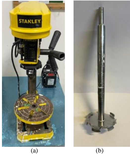
Figura 18 - Materiais e equipamentos utilizados para a fabricação das tintas: a) Furadeira de bancada e b) Disco dispersor
