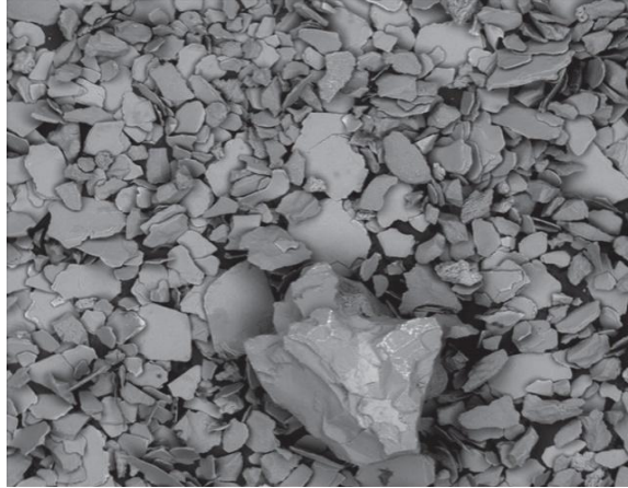
Figura 4 - Imagens obtidas com microscópio eletrônico de transmissão (MET) Caulim
