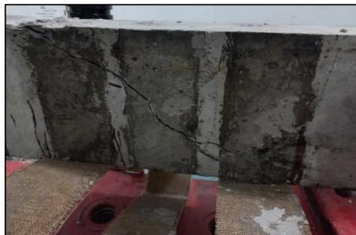
b) Viga JGJ com descolamento das faixas e destacamento parcial do concreto.
