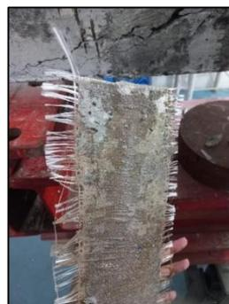
d) Viga GJGJ com destacamento parcial de concreto.
