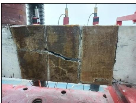
e) Viga JJ com ruptura das faixas de FRP.
