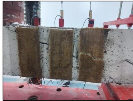
f) Viga JJJ com ruptura e descolamento de faixas.
