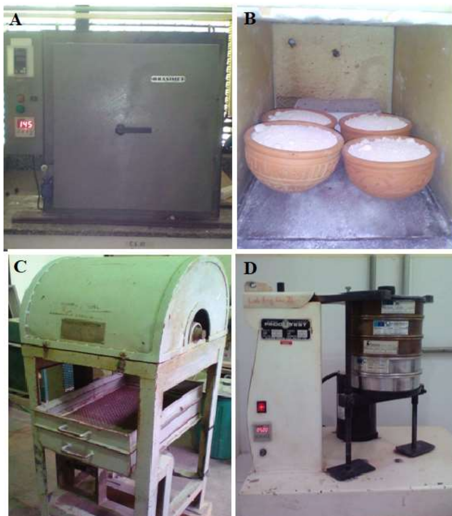
Figura 3.9: Em A mostra o forno mufla; em B o caulim calcinado; O moinho de bolas em C; E em D o Rot-up (modelo PRODUTEST) com as peneiras Tyler ABNT (19,1 mm).
