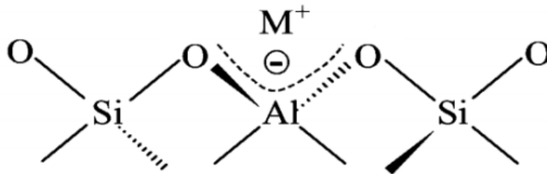
Figura 1: Esquema ilustrativo mostrando as unidades básicas das zeólitas e o cátion de compensação ( M^+ ).
