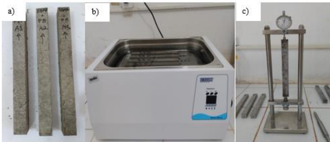
Figura 24 - a) Barras após a desmoldagem e b) Barras no banho-termorregulador; c) Etapa de medição da variação linear da barra.
