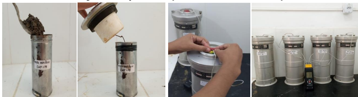
Figura 25 - Etapas de execução do ensaio de calor de hidratação.
