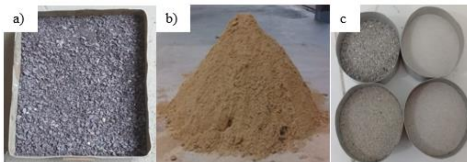
Figura 15 – Agregados: a) pedrisco; b) areia natural e c) areia normal padrão IPT.
