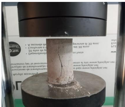
Figura 21 – Ensaio de compressão axial do cimento.
