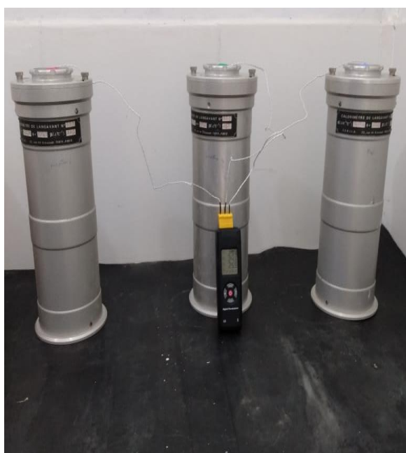
Figura 2-Esquema do ensaio do calor de hidratação pelo método da Garrafa de Langavant .
