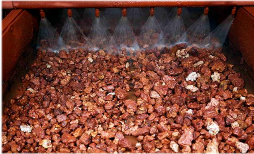
Figura 5.5 - Processo de lavagem da bauxita.
