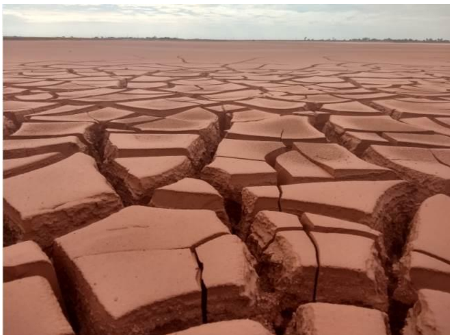
Figura 5.4 - Reservatório de rejeito adensado utilizado para coleta de material.
