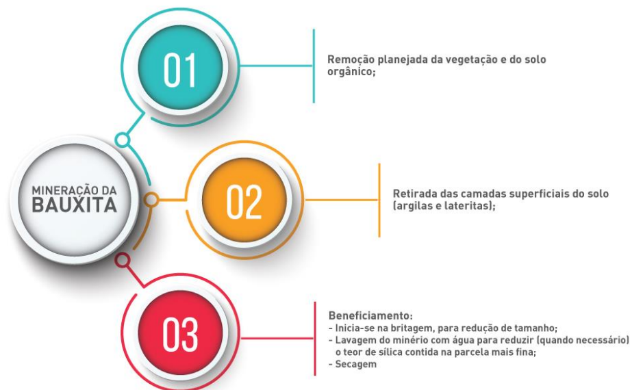
Figura 4.2 - Processo de beneficiamento simplificado da Bauxita.
