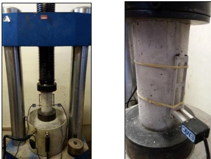
**Figura 4.5 – Ensaio de determinação do módulo de elasticidade do concreto**
