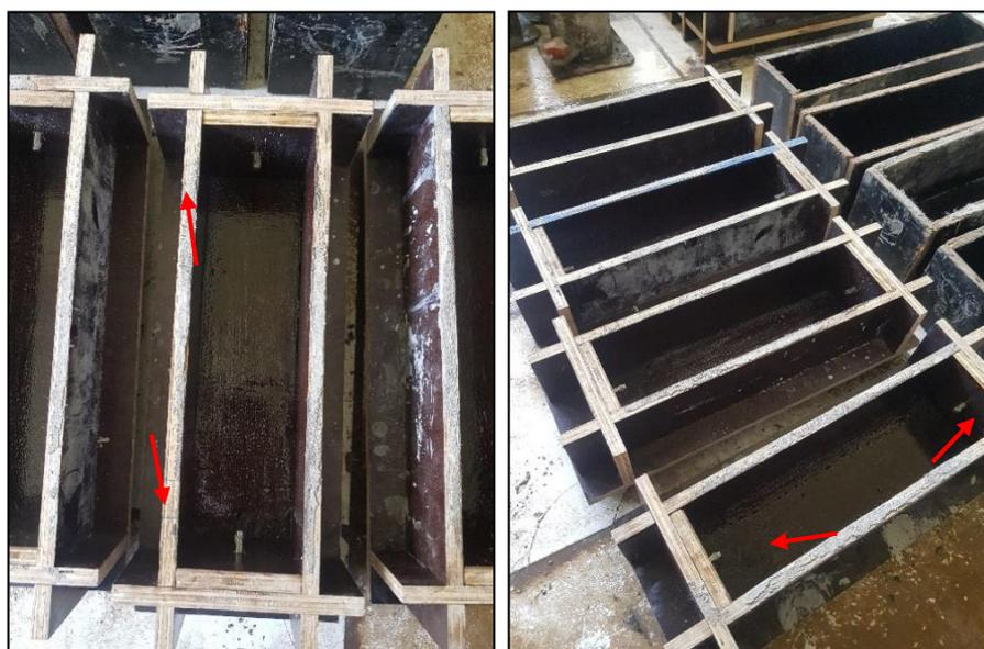
**Figura 3.4 – Molde adaptado desenvolvido para o ensaio de variação dimensional**
