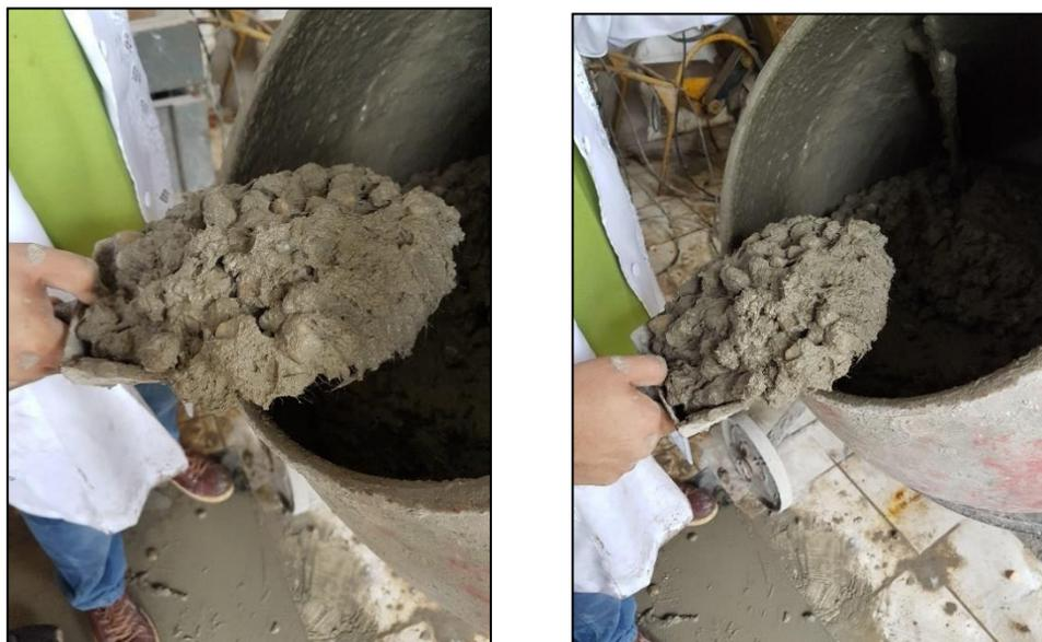
**Figura 4.1 – Preparo de concreto com adição da microfibras de polipropileno**
