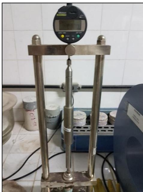
**Figura 3.6 Aparelho comparador com a barra padrão**
