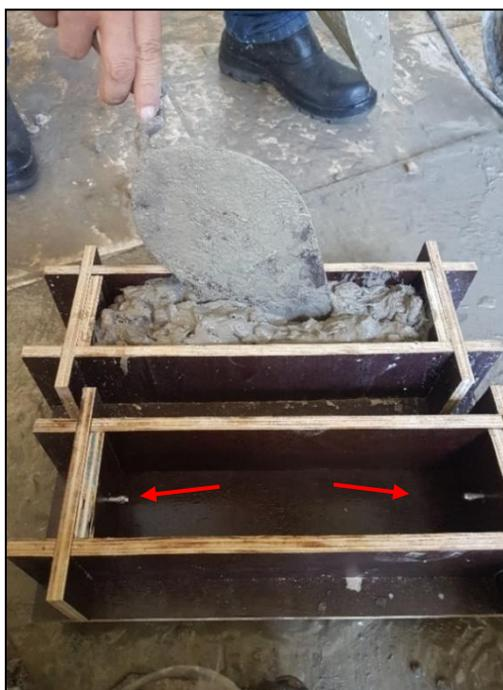
**Figura 3.5 – Moldagem do corpo de prova para ensaio de variação dimensional**
