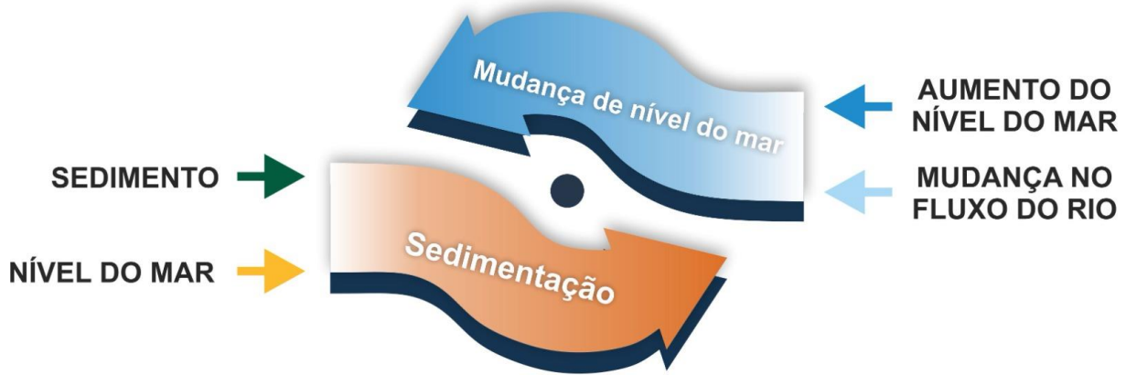
Figura 8 - Diagrama de equilíbrio para estuários entre as taxas de modificação do nível do mar e do fluxo fluvial e sedimentação com entradas de sedimentos terrígenos e marítimos
