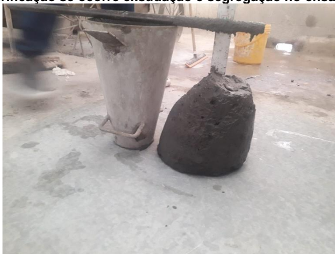
Figura 4.5 – Verificação se ocorre exsudação e segregação no ensaio de slump test
