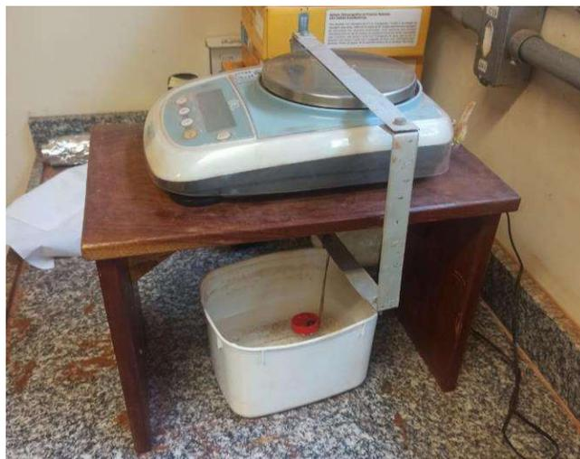
Figura 3.6 – Aparato para medida de massa imersa.
