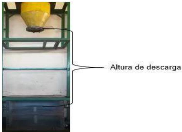
Figura 3.9 - Definição da altura de descarga.
