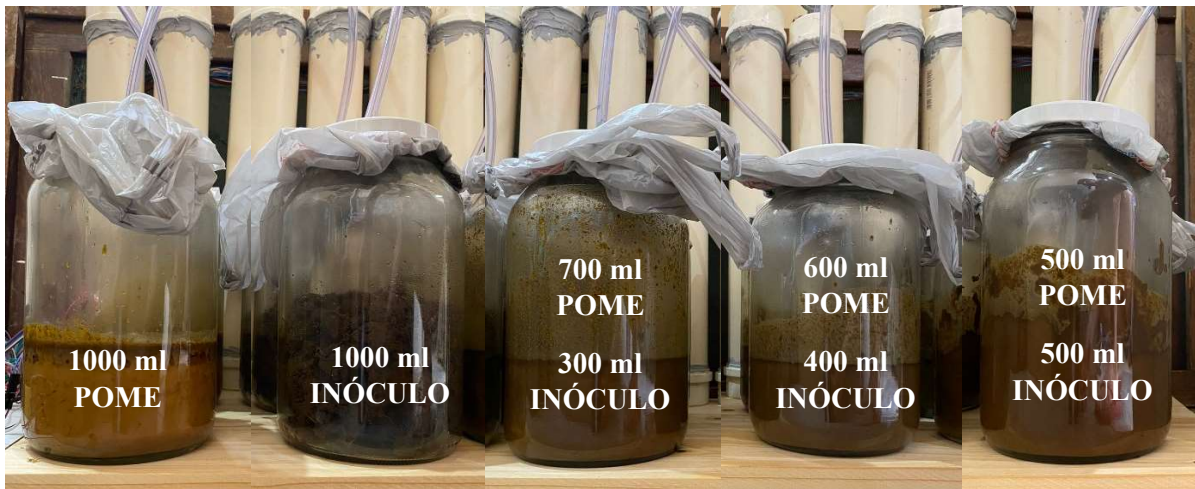
Figura 23 - Fermentadores com os tratamentos indicados no quadro 02
