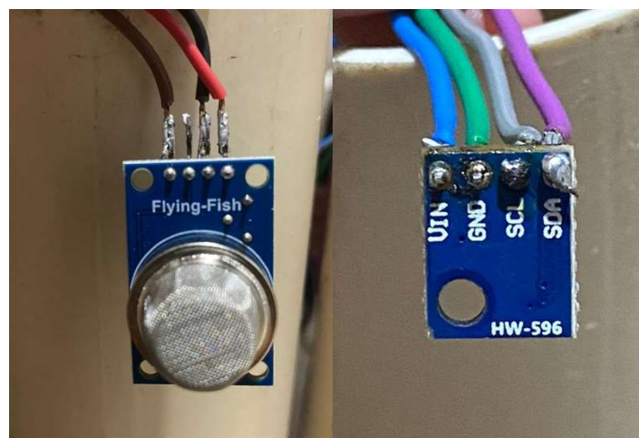
Figura 21 – Sensores (A – Sensor de Concentração de Metano) (B – Sensor de Pressão e Temperatura) (C – Sensores alocados no gasômetro)
